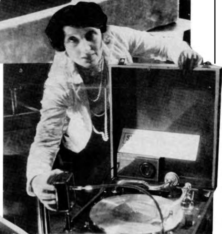
In London zeigte die Erfinderin Mrs. Sheldon Wilkinson (oben) ihre Apparatur zur Aufnahme von Heim-Tonfilmen. Man erkennt in ihrer Hand die Aufnahmekamera, die mittels einer biegsamen Welle gekuppelt ist mit dem Laufwerk eines Grammophons. Die Platten werden über ein Mikrophon besprochen. Phot. A. A. Gulliland
